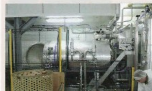
Le chargement/déchargement du Shaka de Steriflow est entièrement automatisé, des barrières isolent le procédé. 1 h 20, de la mise en bocaux jusqu'à la palette. Les bocaux n'ont pas à être repris pour homogénéiser la soupe.
