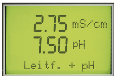
Gleichzeitige Messung von Leitfähigkeit und pH-Wert
