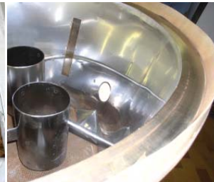
Sensor Litronic-FMS II im Wirbelschicht- trockner bei der Saatgutproduktion.
