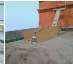
Sensor Litronic-FMS II im Gleitschuh- schlitten für Quarzsand.
