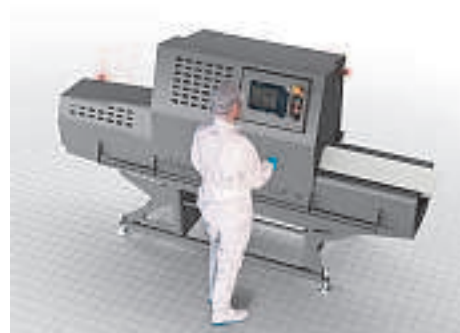
Die offene Konstruktion des I-Cut 10 trägt zu einem hohen hygienischen Standard bei
