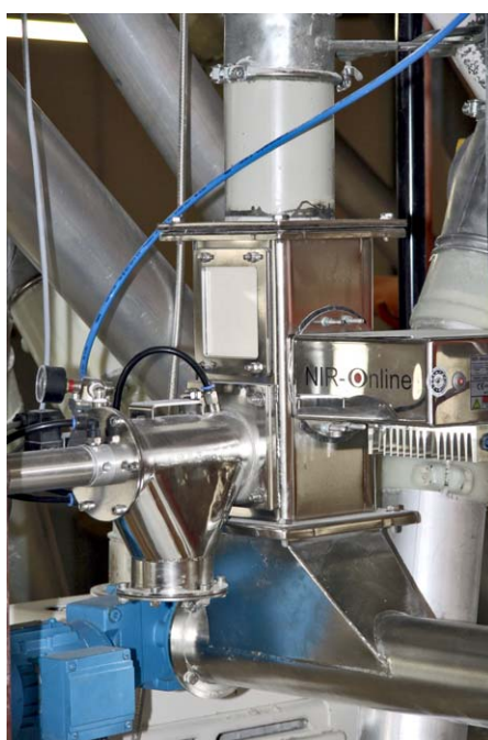
Mit der Infrarot-Spektroskopie lassen sich Produkte und deren Qualität oder Mischverhältnisse kontrollieren.
