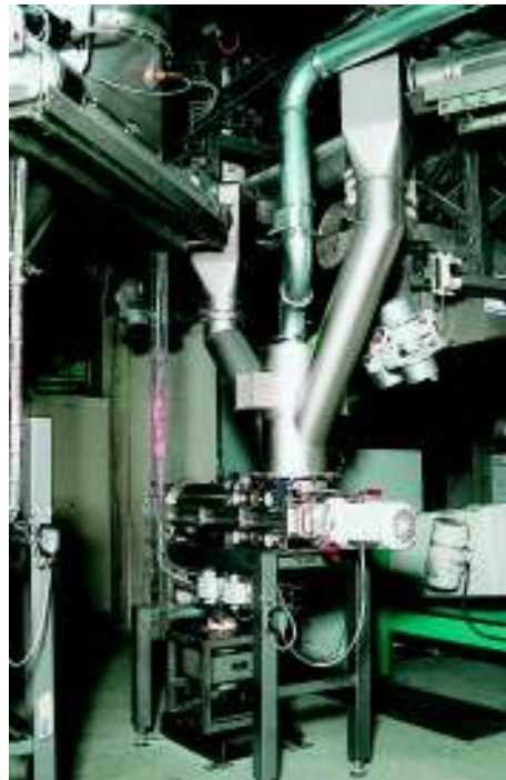
Schüttgüter wie Mehl, Flocken oder Hülsenfrüchte werden im freien Fall von einem Metallseparator geprüft, verunreinigte Produkte sofort ausgeschieden
