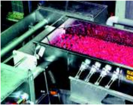
Vor der Weiterverarbeitung der Rohware zu hochwertigen Fruchtzubereitungen werden Fremdkörper und minderwertige Beeren mithilfe einer Laseranlage eliminiert
