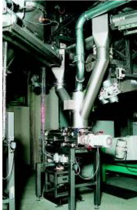
Schüttgüter wie Mehl, Flocken oder Hülsenfrüchte werden im freien Fall von einem Metallseparator geprüft, verunreinigte Produkte sofort ausgeschieden
