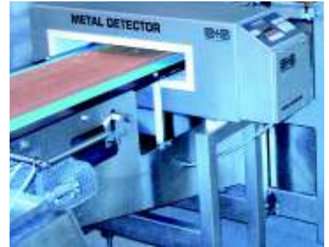
Zum Schutz der Schneidmesser überprüft ein massgeschneiderter Tunnel-Metalldetektor den Teigstrang auf Verunreinigungen
